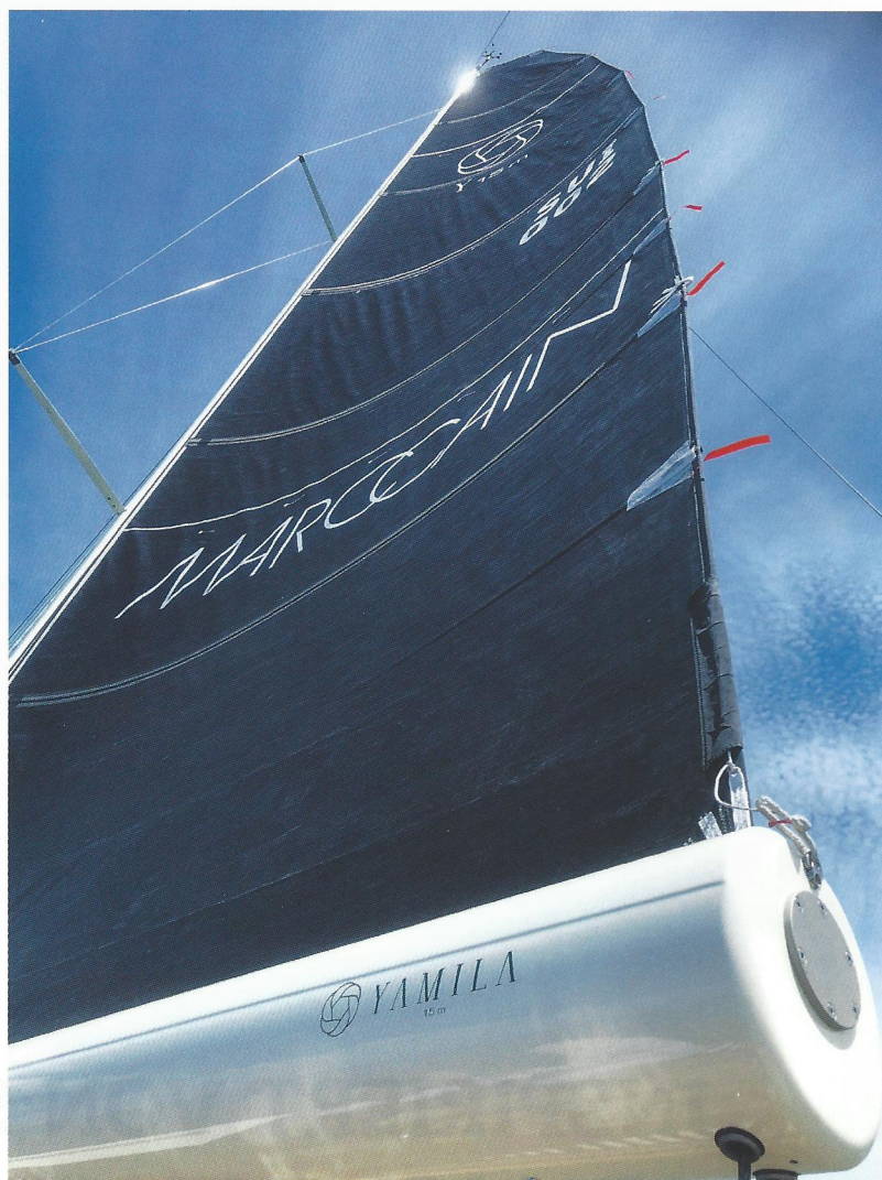
Foto unten: Jungfern-Fahrt und Segel-Test mit Bravour bestanden: Besegelt ist die YAMILA 15m mit einem 72 Quadratmeter messenden Gross, einer Fock/Genua mit 41 Quadratmetern, einem Code Zero mit 108 und einem Gennaker mit 213 Quadratmetern Segelfläche. Mast, Baum und Hubtechnik werden mit viel Know-How „inhouse“ gefertigt.
