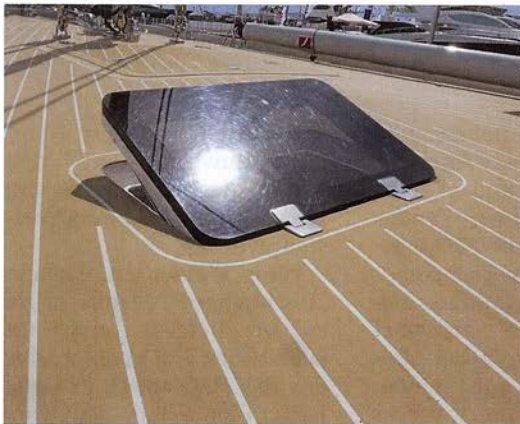
Die Heinrich-Werft ist Spezialist für Esthec-Decks. Mit der Teakalternative aus Kunststoff lassen sich interessante und pflegeleichte Decks gestalten.
