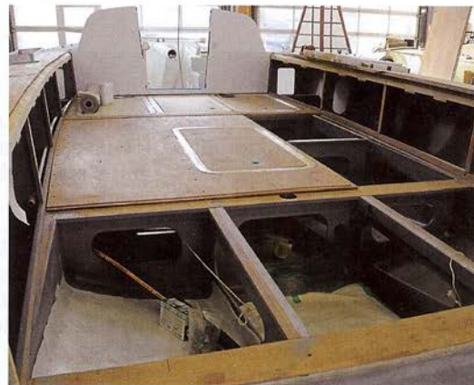
Neubau einer 12 Meter-Yacht von Juliane Hempel. Der Leistenbau wiegt nur 3,45 t, hat einen Hubkiel und fährt rund 100 qm am Kohlefaserrigg.
