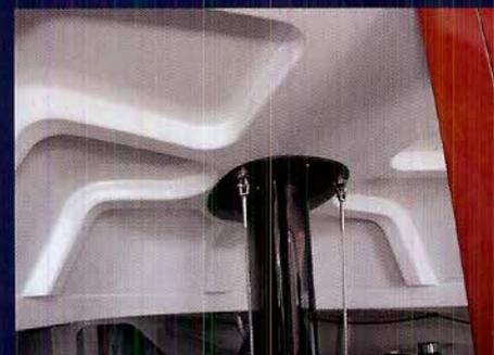
Der Aufbau nimmt die Kräfte von Ballast und Mast auf und leitet sie in Schlinge und Decksbalken weiter.
