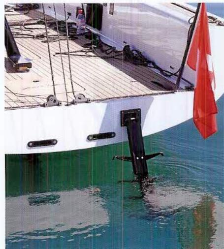
Aufwendige Sache: Die Heckleiter verschwindet mit eingeklappten Stufen im Spiegel.
