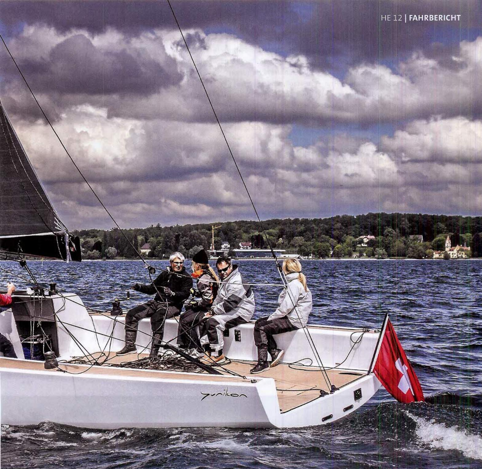
Die „Yunikon“ ist ein Einzelbau und soll auch kein zweites Mal gebaut werden, erklärt Peter Minder, Eigentümer der Heinrich-Werft in Kreuzlingen. Deshalb wurde der Rumpf als konventioneller Leistenbau über Mallen hergestellt. „Ich kann bei einem Einzelbau keine 200.000 Franken in einem vakuumdichten Block versenken“, erklärt Minder.
