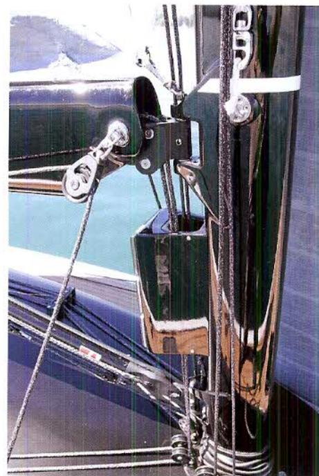
Hier läuft alles zusammen: Die Großschot ist nach dem deutschen System geschoren und läuft in einem Kanal unter Deck nach achtern zur Winsch. Fallen und Strecker enden in Klemmen auf dem Aufbau.
