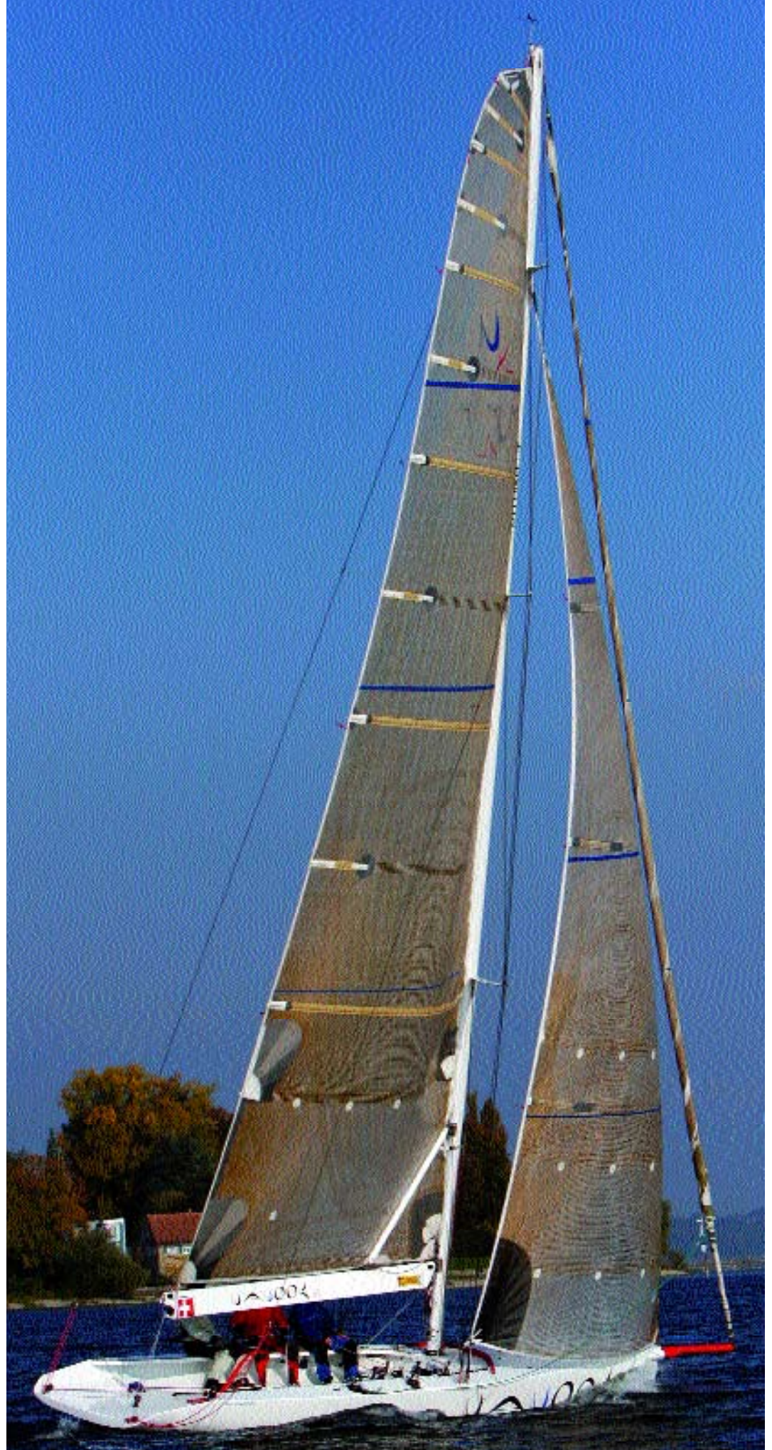
An der unteren Segellatte leicht zu erkennen ist das tiefe Profil des Großsegels, das gewaltige Kräfte erzeugt. Mit einem flachen Segel dürfte das Boot bei mehr Wind erheblich leichter zu handhaben sein ohne bei wenig Wind wesentliche Leistungseinbußen zu verzeichnen.
