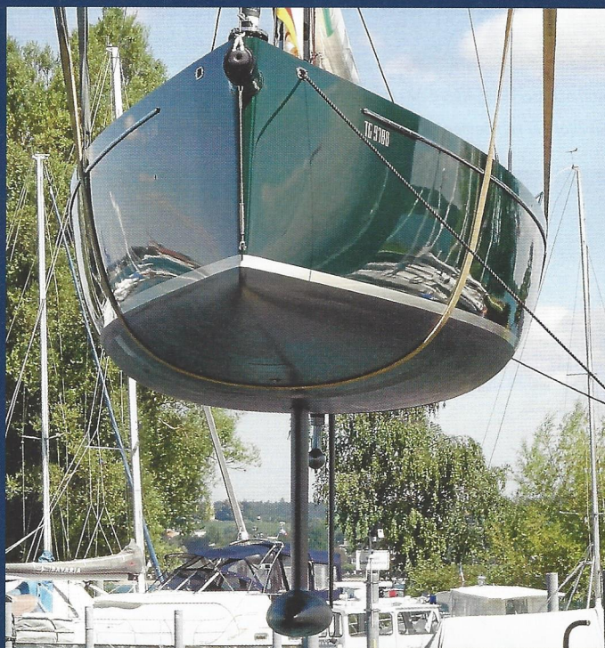
Moderne, flache Unterwasserlinien mit gestreckten, hocheffektiven Anhängen und Ballastbulb am unteren Ende der hydraulisch verstellbaren Kielflosse zeichnen die Yamila aus.
