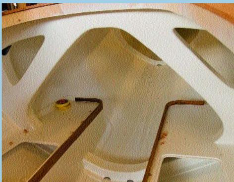
**Die geschlossene Mastbrücke fängt den Mastdruck auf.**
